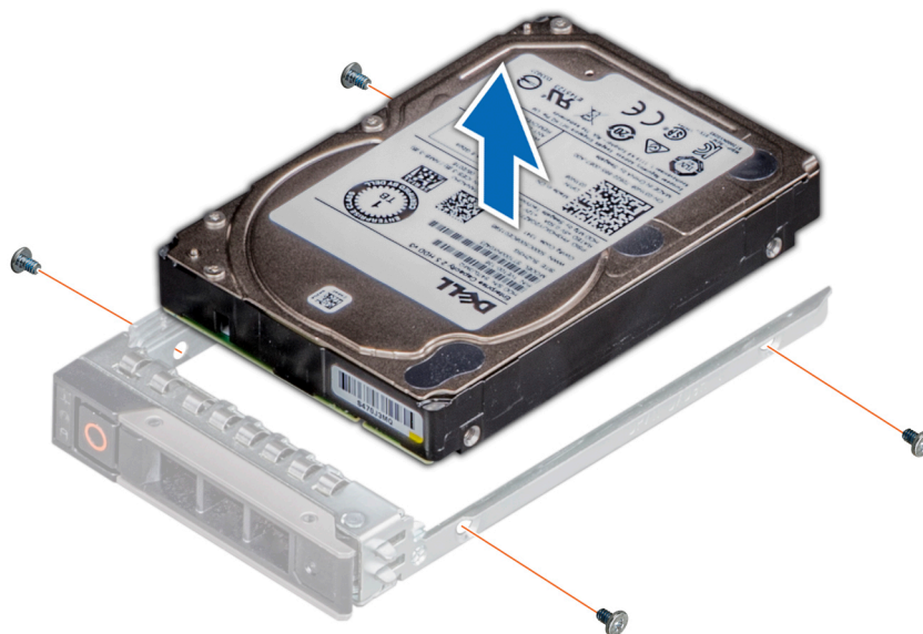
図 57. ハードドライブキャリアからのハードドライブの取り外し
