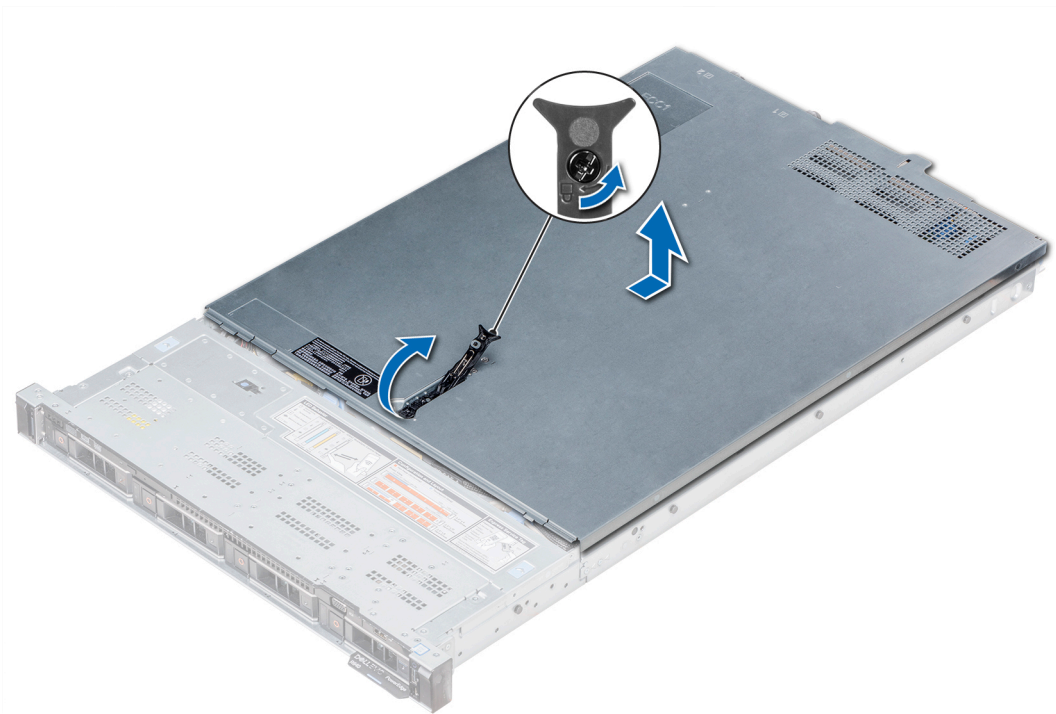
図 16. システムカバーの取り外し
