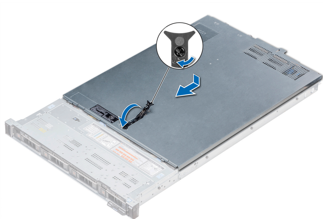
図 17. システムカバーの取り付け
